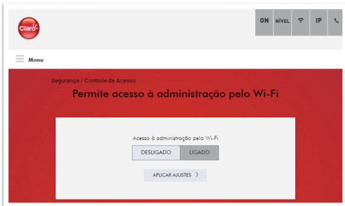
Figura 30 – Tela de configuração do acesso a página de administração do modem via Wi-Fi
